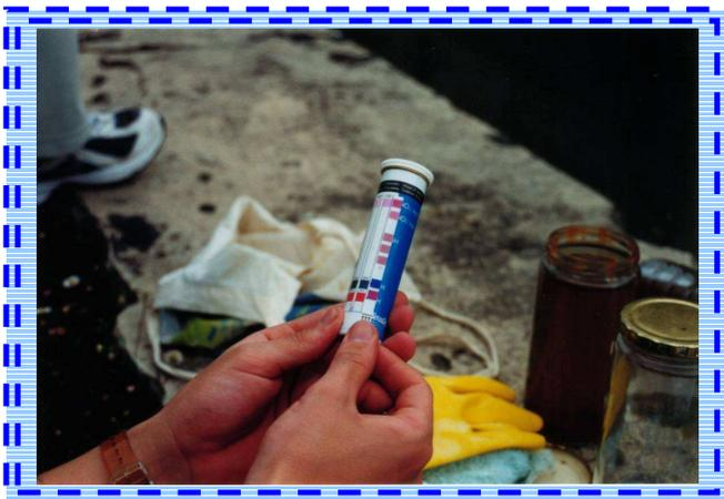
**FOTO 16.** Efectuando las pruebas de pH, dureza total y dureza de carbonatos, nitratos y nitritos de las muestras de agua.
