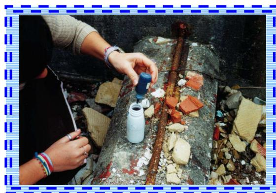
**FOTO 20.** Prueba del azul de metileno para comprobar la presencia de materia orgánica en el agua.
