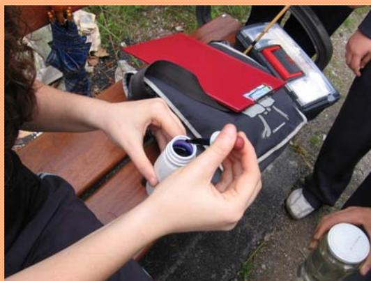
**FOTO 15.-** Realizando la prueba del azul del metileno.
