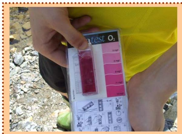
**FOTO 3.** Realizando la prueba del O<sub>2</sub> disuelto.
