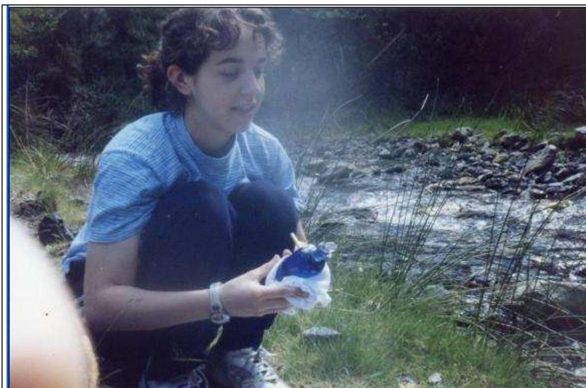
**FOTO 4.** Con el azul del metileno para conocer la contaminación orgánica.
